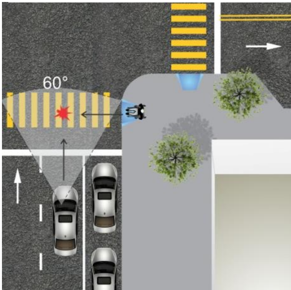
Ilustración 28: Ángulo de visión del conductor en una intersección con estacionamientos adyacente, la distancia de inicio del cruce peatonal no permite al usuario ser observado a tiempo
