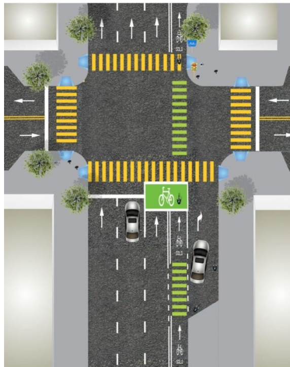
Ilustración 46: Intersección de infraestructura ciclista segregada con estacionamiento adyacente y vuelta derecha.
